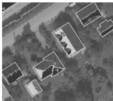
Abb. 12: Geeignete Solarflächen (dunkle Dachflächen - sehr gut, helle Dachflächen - gut)
